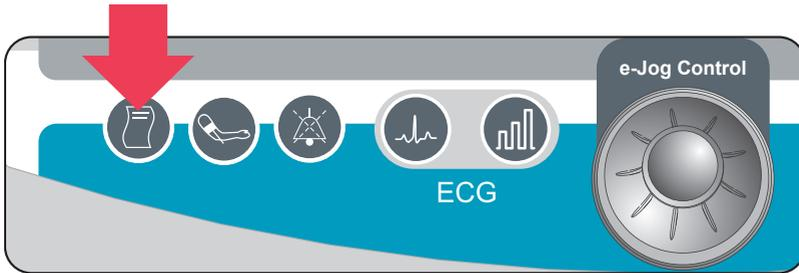
La impresora térmica permite imprimir informes manuales o automáticos, por evento, por choque o electrocardiograma. El accionamiento se realiza a través de la tecla de impresión, ubicada en el panel frontal del equipo o por el menú "impresión", usando el botón e-jog.
